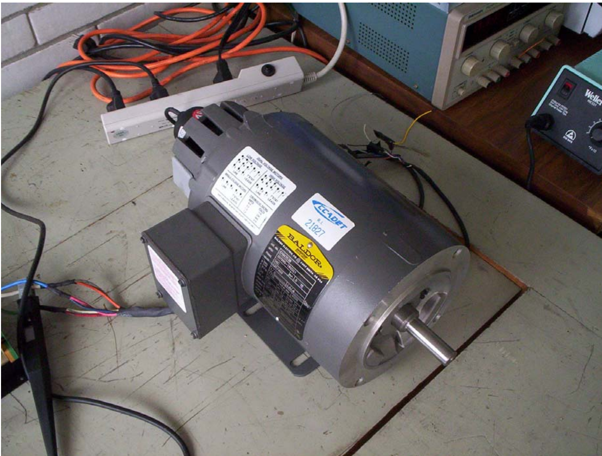
Figura 3.47. Motor trifásico de \frac{1}{2} Hp., empleado como carga para las pruebas realizadas sobre el sistema implementado.
