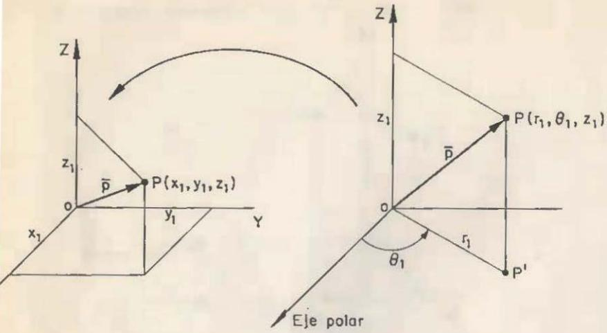
Figura III.38 Transformación de coordenadas
