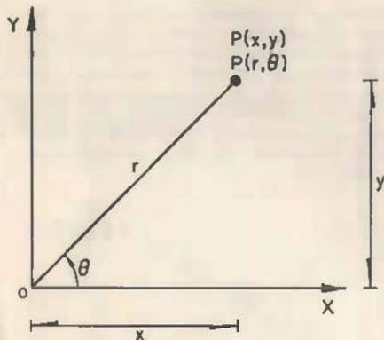
Figura III.15 Sistema polar y sistema cartesiano
