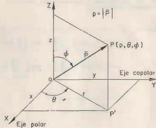
Figura III.42 Transformación de coordenadas
