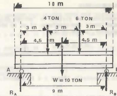
$$W = \text{peso total de la viga} = 1.0 \frac{\text{Ton}}{\text{m}} \times 10 \text{ m} = 10 \text{ Ton (localizado a la mitad de la viga)}$$
