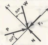
Para la fricción en seco, la fuerza  $F_f$  que se genera es igual al producto del coeficiente de fricción  $\mu$  por la magnitud de la reacción normal  $N$ :
