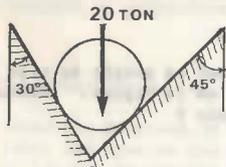
a) Cilindro que descansa sobre los planos  $30^\circ$  y  $45^\circ$
