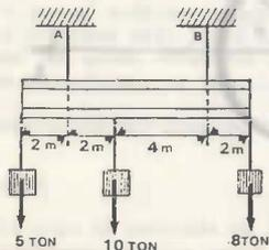
c) Viga suspendida de los apoyos A y B y cargada con los 3 cuerpos de 5 ton, 10 ton y 8 ton. (peso de la viga 100 kg/m)
