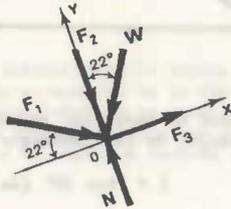
Sobre el eje Y el sistema está equilibrado, por tanto, sólo la componente de la resultante que se encuentra en el eje X, que es la dirección del movimiento, produce trabajo; en esta forma el problema se resuelve utilizando esa componente.
