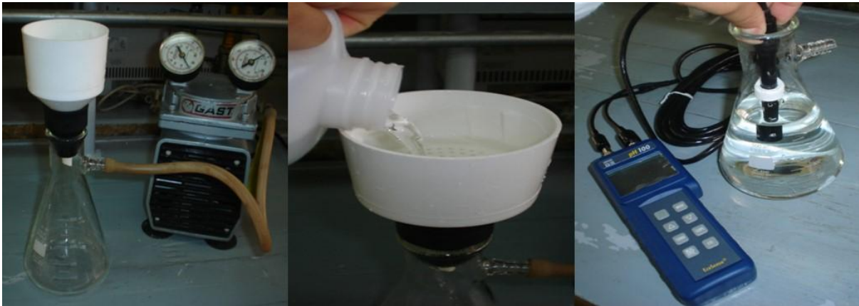
Figura 16. Filtrado de Lixiviado.
