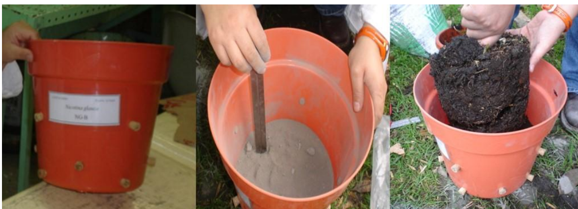
Figura 8. Arreglo del sistema jal-suelo y planta para la especie N. glauca .
