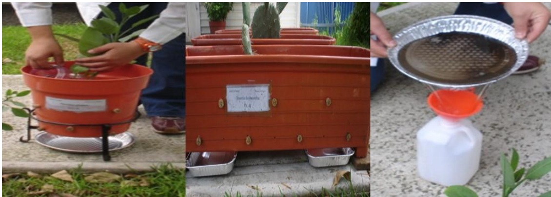
Figura 15. Toma de muestras de Lixiviados.
