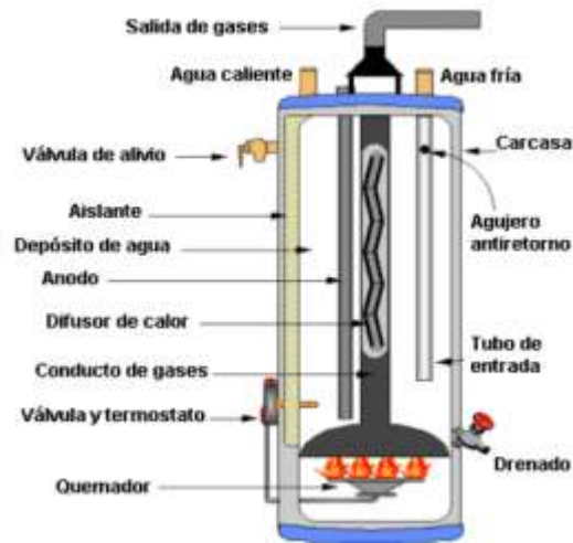
Ilustración 13 Esquema del calentador de depósito con gas
