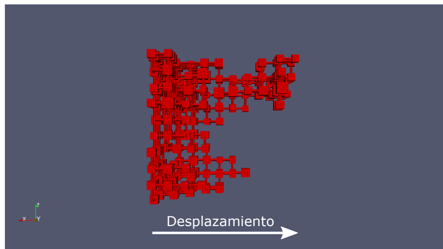
Figura 6.6: Perfil de invasión de mercurio hasta el momento de la ruptura.
