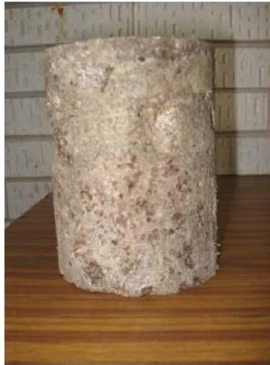
Figura 3.7. Núcleo cortado a las dimensiones de trabajo.
