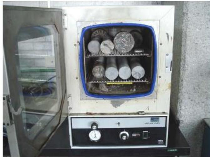
**Figura 3.9. Horno de Vacío.**
