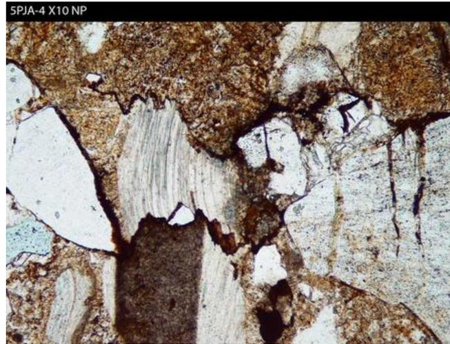
Figura 1.20. Detalle de superficie estilolítica (compactación química) en grainstone packstone bioclástico. Cretácico inferior (Aptiense).
