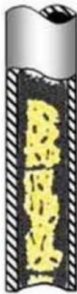
Figura 4.26. Flujo transicional en tuberías verticales.
