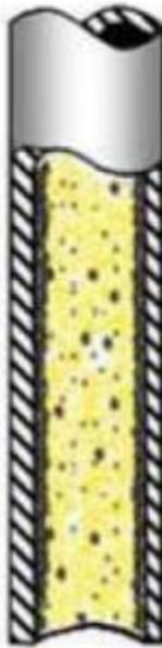
Figura. 4.27. Flujo niebla caracterizado por alto flujo de gas por el centro de la tubería, acompañado por una película casi uniforme de líquido que viaja a menor velocidad en las paredes de la tubería.
