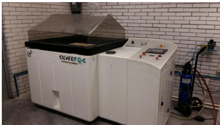
Figura 3.10 Cámara de niebla salina comercial capaz de efectuar diversos ensayos estandarizados.
