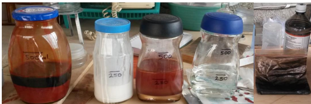
Figura 4.1 De izquierda a derecha, los recubrimientos óxido de hierro rojo, óxido de titanio, óxido de hierro marrón y barniz de poliuretano, pigmento de óxido de cromo y solvente para poliuretano.
