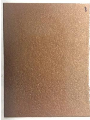
Figura 5.16 Probeta con una película generada a partir de la nueva formulación.
