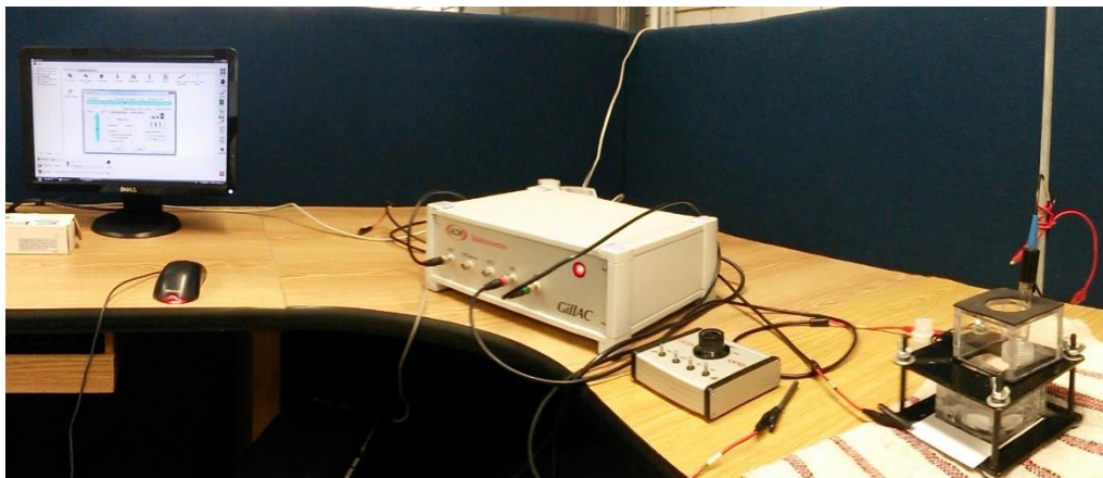
Figura 5.18 Para la prueba EIS se utilizó potenciostato ACM Instruments GillAC.
