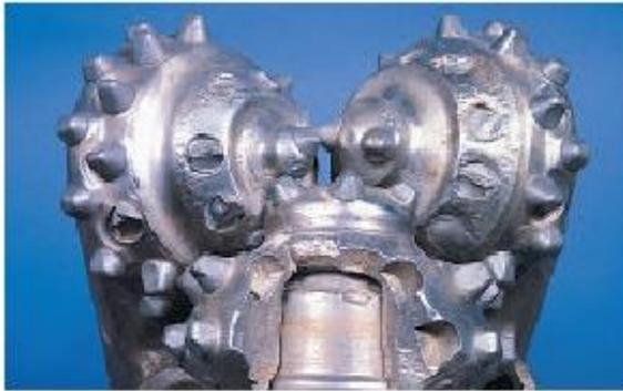
*Figura 48 daño por cono roto en barrena tricónica.*
