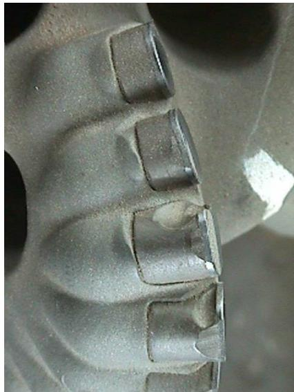
*Figura 44 Desgaste por erosión*
