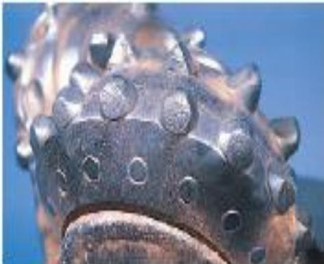
*Figura 57 sobre calentamiento de una barrena*
