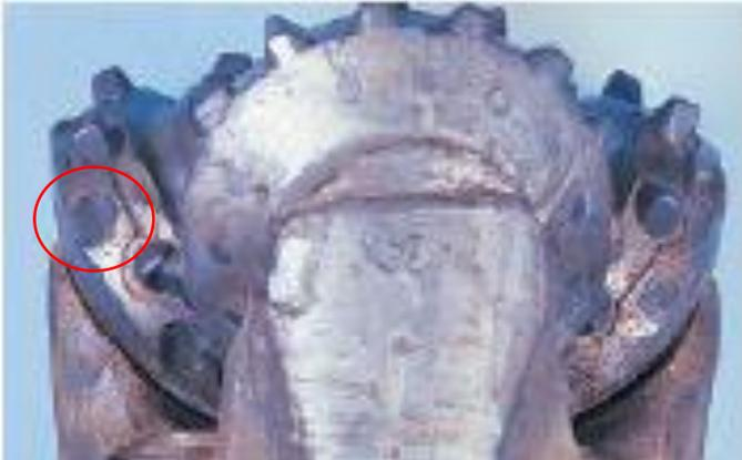
*Figura 61 daño por diente perdido.*
