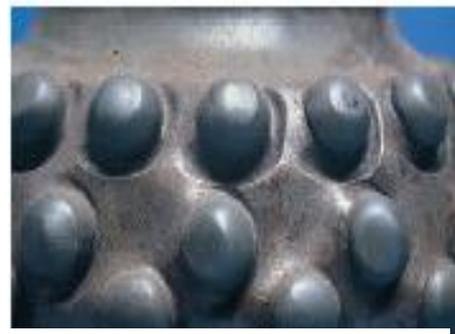
*Figura 55 barrena erosionada*
