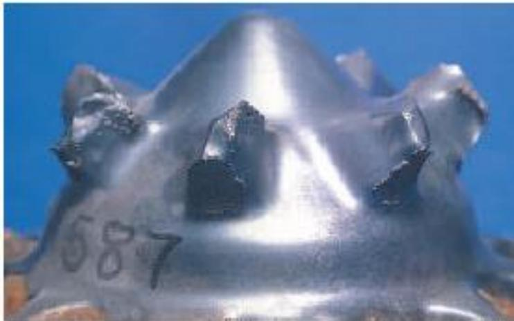
*Figura 67 desgaste autoafilado.*
