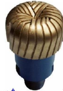
*Figura 11 Barrena de Diamante impregnado*
