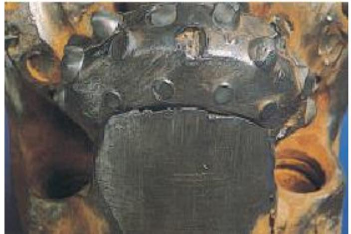
*Figura 66 barrena con daño en la pierna.*
