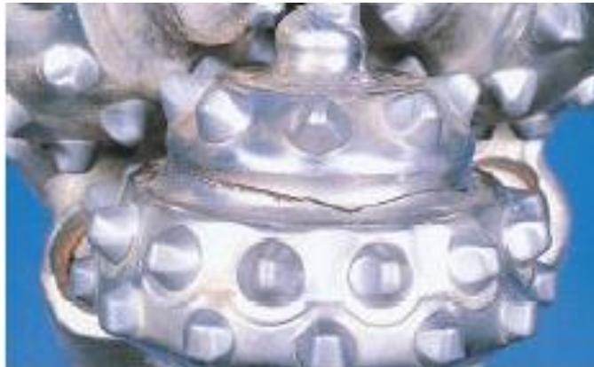
*Figura 51 cono fisurado.*
