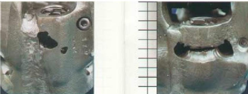
*Figura 69 daño por lavado.*
