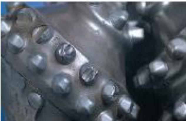
Un diente es considerado astillado cuando menos de 1/3 del elemento de corte se ha ido cualquiera sea su causa. Las posibles causas son: mala selección de la barrena, excesivo peso sobre la barrena, excesivas rpm, excesivas cargas de impacto, inadecuado asentamiento de la barrena, etc.
