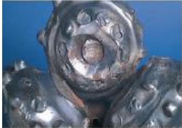
*Figura 54 coroneado de una barrena tricónica.*
