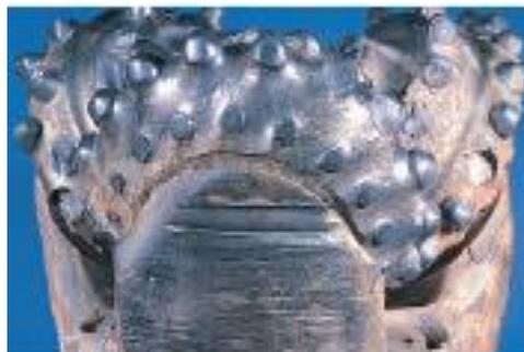
*Figura 58 barrena con daño por chatarra.*
