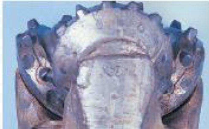
*Figura 63 Daño por forzamiento de barrena*
