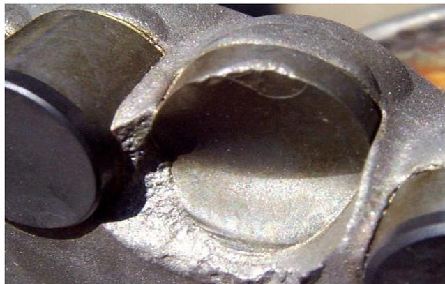
*Figura 39 Falla de Adherencia*
