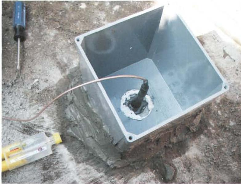
Figura 2.26: Instalación de un acelerómetro en el lomo del tubo (Callejas, 2011).
