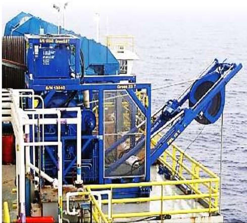
Figura 4. 20 Cabestrante con umbilical colocado en cubierta.<sup>25</sup>
