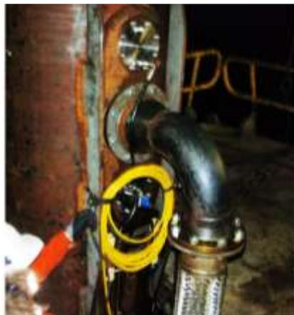
Figura 4. 14 Módulo de succión<sup>25</sup>
