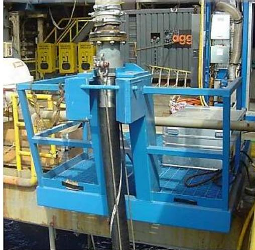
Figura 4. 19 Plataforma de manipulación de la manguera con la línea de retorno del lodo instalado.<sup>25</sup>
