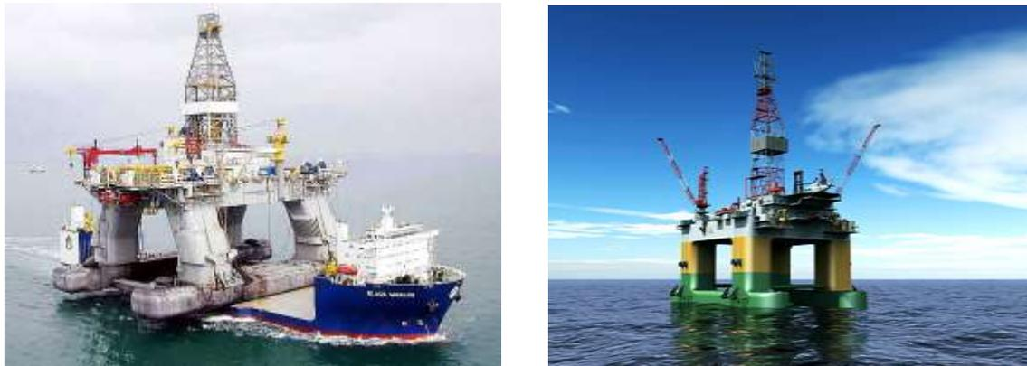
Figura 3. 1 Ejemplo de plataforma semisumergible.
