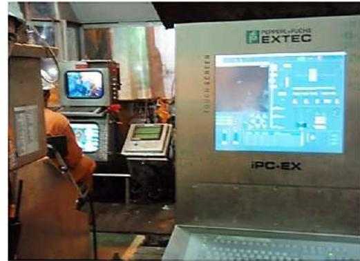
Figura 4. 23 Control del sistema RMR dentro de la cabina del perforador.<sup>25</sup>
