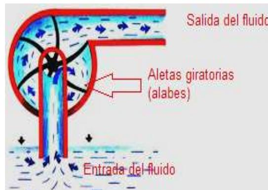
Figura 3. 10 Bomba centrífuga.
