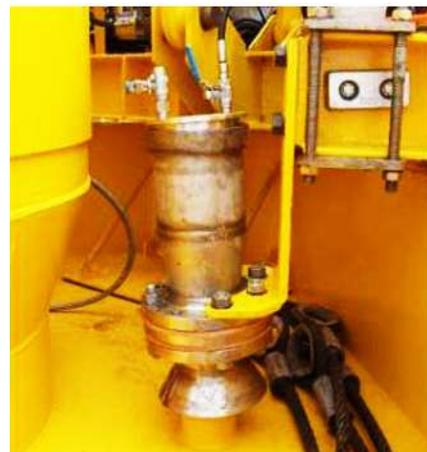
Figura 4. 15 Sensor de presión colocado en módulo de succión.<sup>25</sup>
