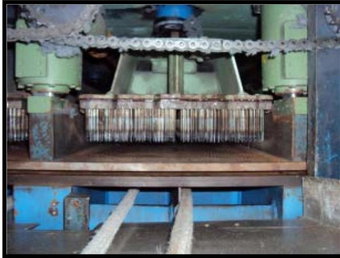
Imagen II.10. Máquina punzonadora para entrelazar las fibras del geosintético
