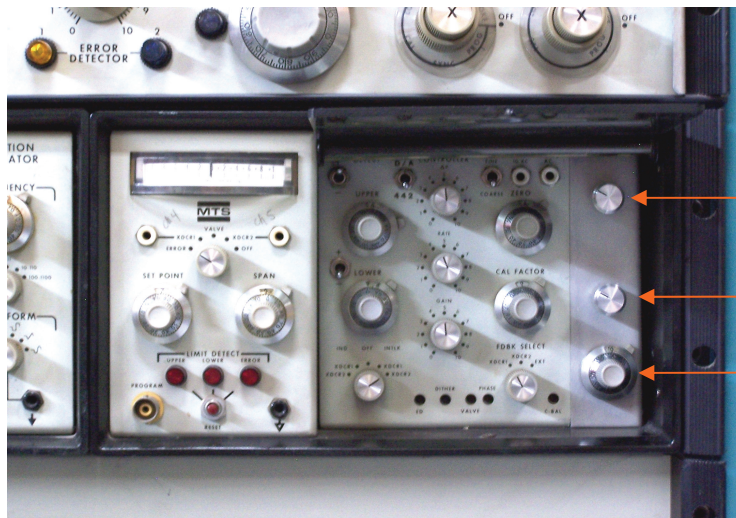
Figura 44 Selectores y potenciómetro instalados en el servocontrolador
