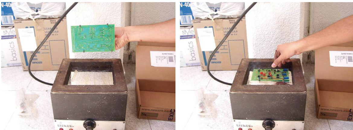
Figura 36 Soldadura en el crisol
