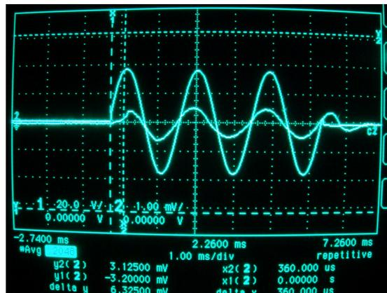
*Figura I-5 Formas de onda obtenidas para los cristales piezoeléctricos*
