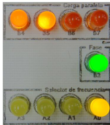
Figura 5-9d Prueba 4 salidas CP, FASE y SF
