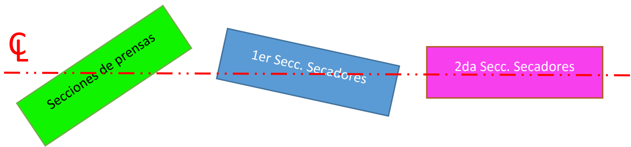
Figura 13. Desalineamiento de las distintas secciones, sólo la segunda sección de secadores se mantiene alineada respecto a la línea de centro.
