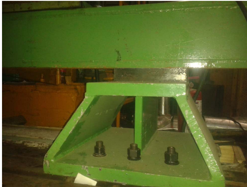
Figura 34. Anclaje de bases a la cola de milano mediante tornillos de cabeza plana, roldanas planas, roldanas de presión y tuerca (todos los tornillos en grado 5).
