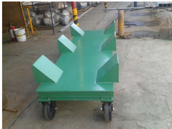
Figura 30. Carro de transporte para los secadores, sobre las superficies triangulares se colocaron polines para evitar que los secadores se maltrataran.
