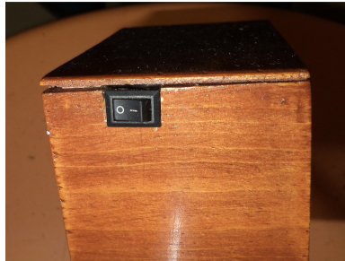
Figura 3.16: Vista superior de la base inferior del bastón inteligente, en la parte superior izquierda se puede apreciar el interruptor del sistema
