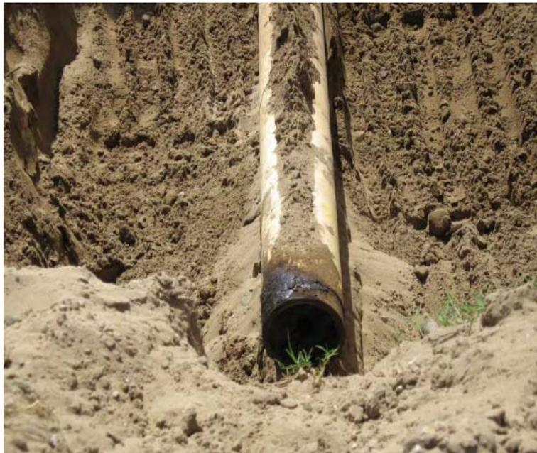
Figura IV.5 Tubería de Producción con depósito de asfalteno correspondiente al pozo A.
