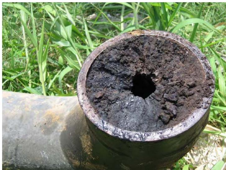
Figura IV.4 Sección de tubería de línea de escurrimiento de 8" con depósito de asfalteno perteneciente al pozo A.
