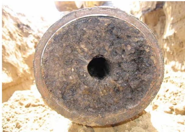
Figura IV.2 Sección de tubería de línea de escurrimiento con depósito de asfalteno perteneciente al pozo A.
