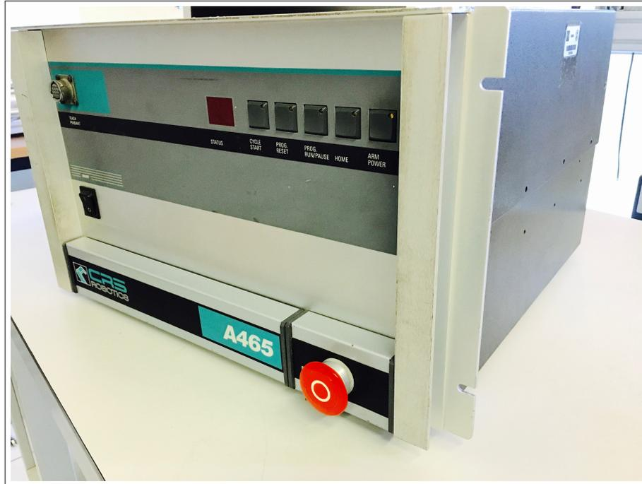
Figura 3.15: Controlador C500 del robot A465.
