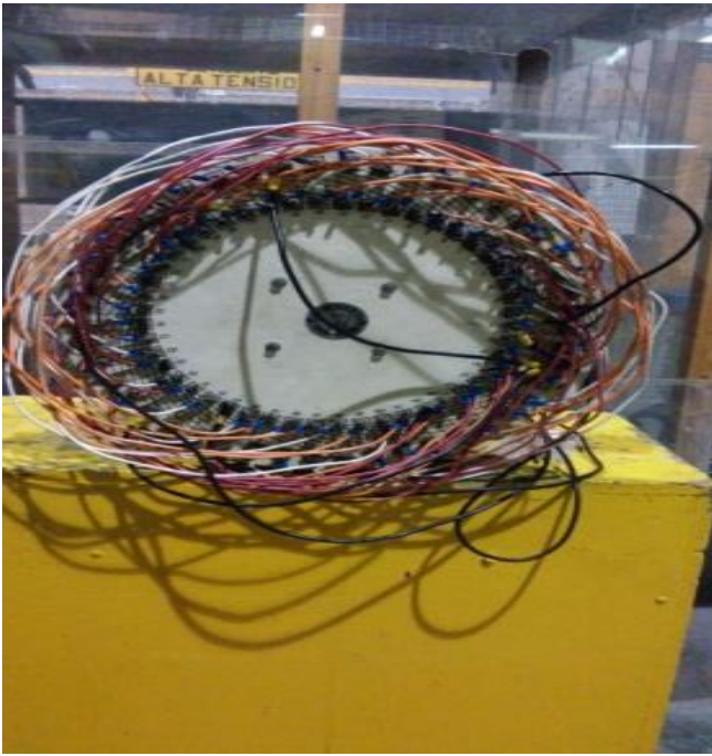
Figura 62: Conexiones del Embobinado Ondulado Trifásico de 4 polos.
