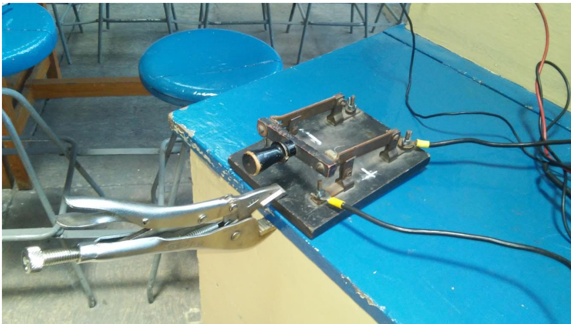
Figura 66: Pruebas del Embobinado Imbricado Monofásico de 6 polos con capacitor de arranque.
