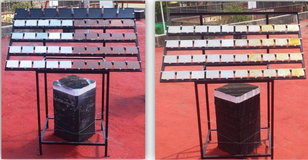
Figura 1.3.1.1 Probetas planas de gravimetría dispuestas sobre el pupitre de corrosión.
