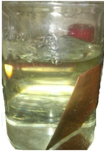
Fig. 2.4.5.1 Imagen del proceso de decapado de las probetas de Cobre con HCl aireado con Nitrógeno
