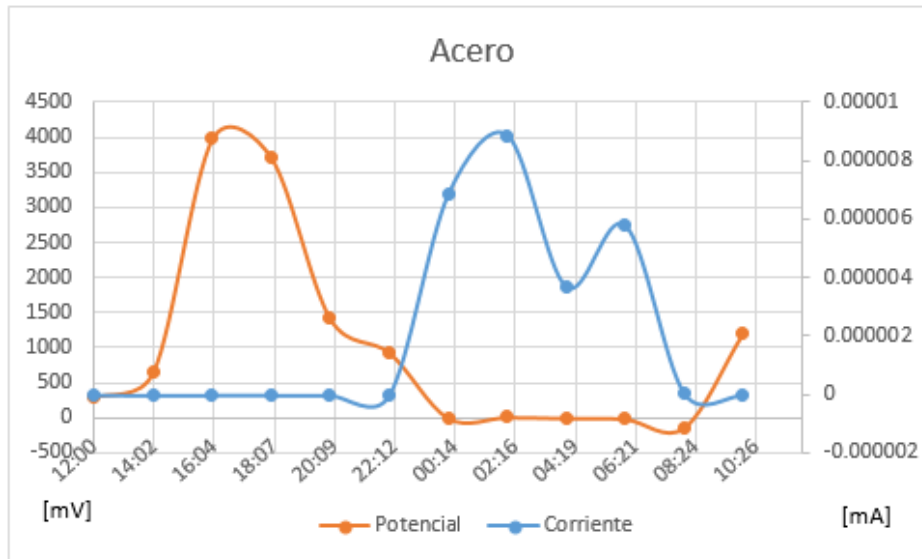
Fig. 3.3.1.10 Valores promedio de potencial y corriente para el acero del 19 de Agosto de 2013 a lo largo de 24 horas del monitoreo
