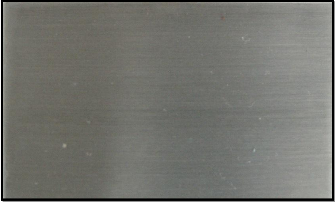
Fig. 3.1.2.2 Probeta de aluminio después de 3 meses de exposición; en la probeta sólo se alcanzan a ver algunos puntos blancos en donde se tiene una corrosión localizada.
