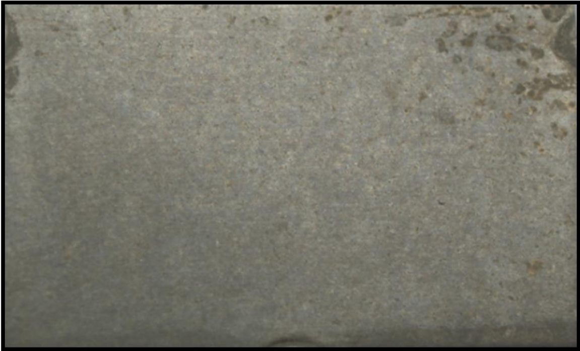
Fig. 3.1.4.5 Probeta de zinc después de 12 meses de exposición; se puede apreciar el incremento de los productos de corrosión; sin embargo este incremento no se dio de manera elevada.
