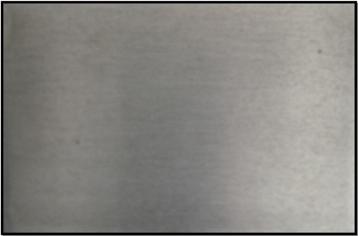
Fig. 3.1.2.3 Probeta de aluminio después de 6 meses de exposición; la probeta presenta manchas de manera generalizada, lo que indica una corrosión por picaduras en más puntos de la superficie.
