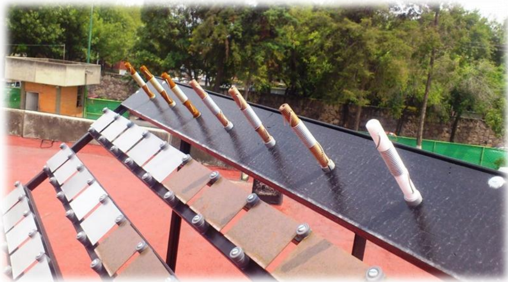
Fig. 2.5.3 Probetas de alambre sobre tornillo, inicio de la exposición.
