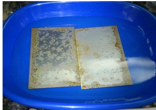
Fig. 2.4.5.3 Imagen del proceso de decapado de Acero con HCl + Hexametil tetramina (inhibidor)
