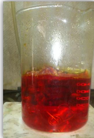
Fig. 2.5.2.1 Decapado de los alambres de Aluminio con H_3PO_4 + CrO_3 a 90 °C
