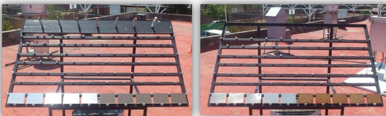
Fig. 2.4.4.6 Pupitres después de 270 días, tercer retiro de probetas planas
