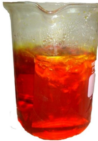
Fig. 2.4.5.2 Imagen del proceso de decapado de las probetas de Aluminio con H_3PO_4 + CrO_3 a 90\text{ }^\circ C
