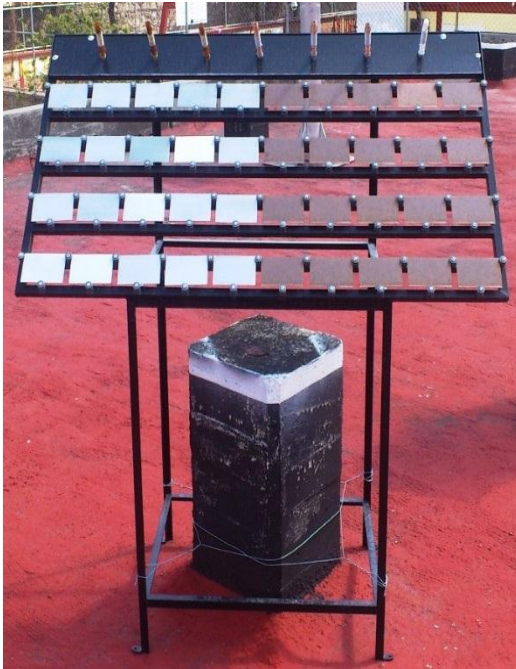
Figura 2.4.4.1 Rack con probetas de Aluminio y Cobre. Probetas de alambre sobre tornillo.
