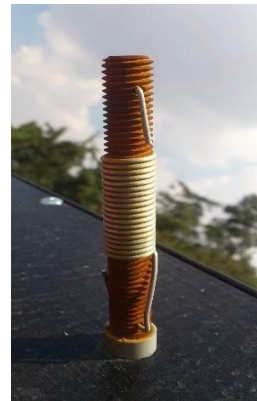
Figuras. 3.2.1.1 Imagen de las probetas de alambre de Aluminio sobre tornillos de Acero después de 90 días de exposición.
