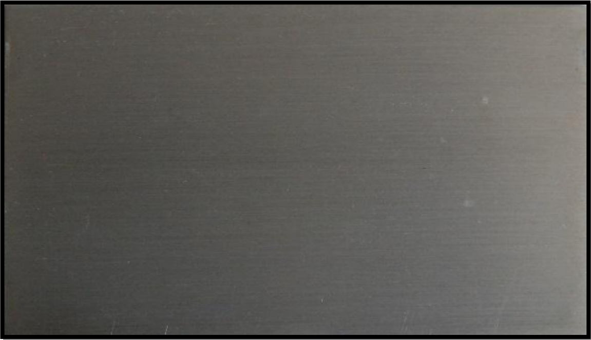
Fig. 3.1.2.4 Probeta de aluminio después de 9 meses de exposición; la probeta ha cambiado de tono y se puede intuir que la corrosión es homogénea en toda la superficie.
