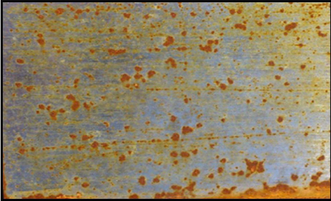
Fig. 3.1.1.1.2. Probeta de acero. Después de 3 meses de exposición se puede apreciar que se comienza a formar una capa de óxido. En algunas partes se forma una capa de óxido al parecer de forma localizada.
