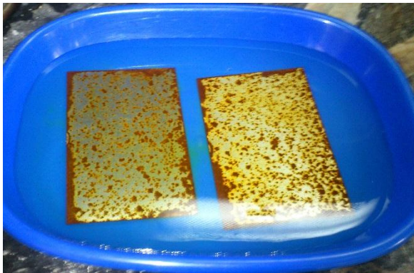
Fig. 2.4.5.3 Imagen del proceso de decapado de Acero con HCl + Hexametil tetramina (inhibidor)
