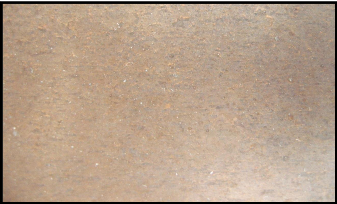
Fig. 3.1.3.3 Probeta de cobre después de 6 meses de exposición; la probeta tiene productos de corrosión extendidos en la superficie y ya no tan localizados.
