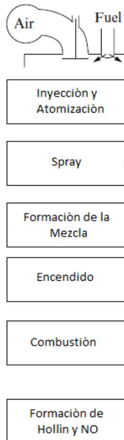
Fig. 1.3 subprocesos involucrados en un motor diésel
