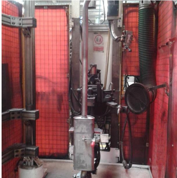
**Fig. 12. Ensamble de resonador y ducto Intermedio (Unión).**
