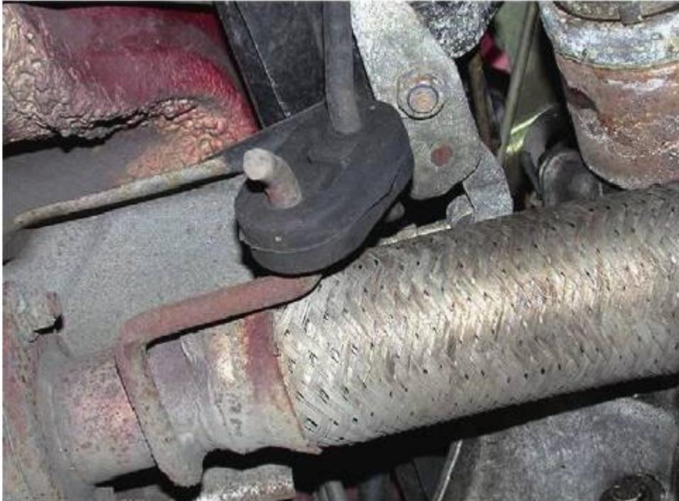
*Fig. 10. Ducto flexible.*
