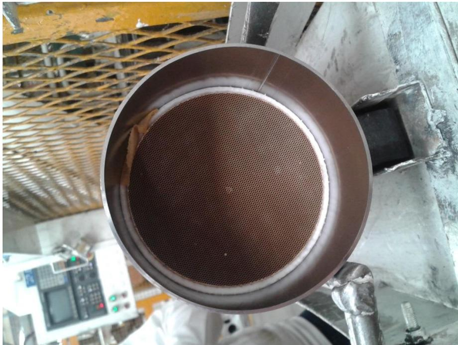
**Fig. 11. Convertidor catalítico (panal cerámico).**
