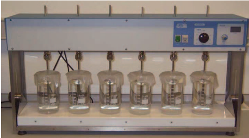
Figura 1.4. Equipo jar-test utilizado en la prueba de lodos (4).
