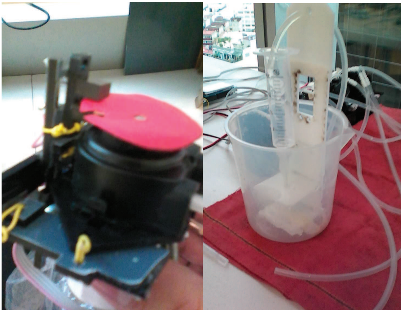
Figura 112. Sensor propuesto para bomba de dosificación efluente
