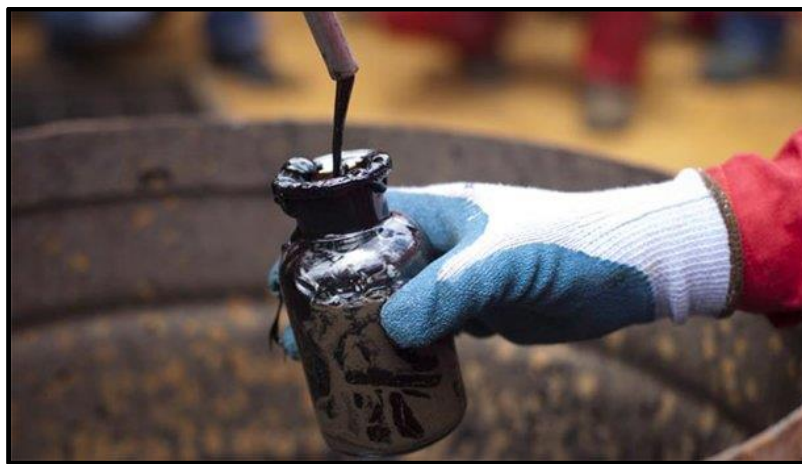
Fig. 7.1. Toma de muestra de aceite pesado en superficie (Samuel Sosa, 2015).
