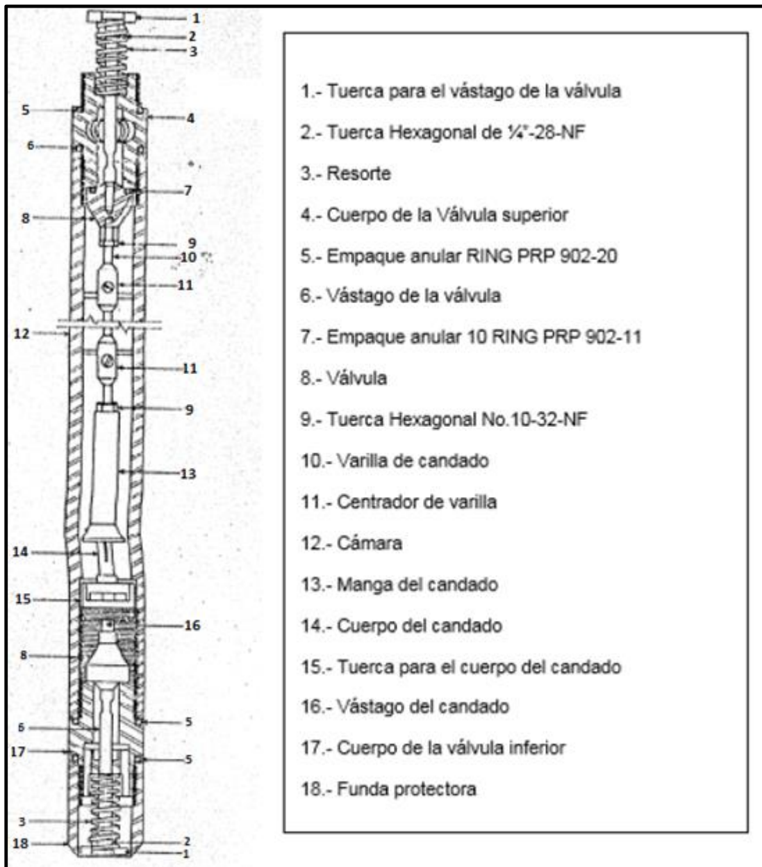
Fig. 7.2. Muestreador de fondo del tipo de circulación, indicando las partes que lo componen.
