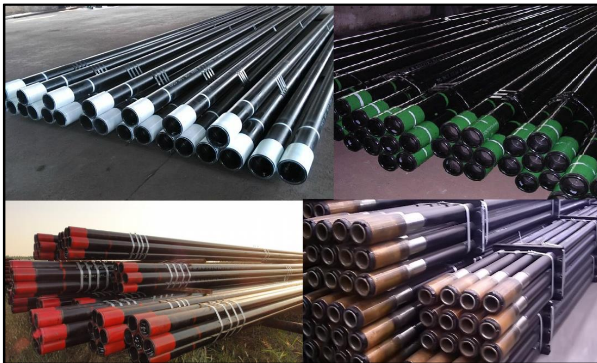
Fig. 2.3. Diversos tramos de tubería de perforación, los cuales pueden ser utilizados para alcanzar el yacimiento.
