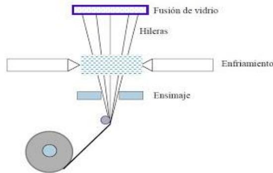
Figura 2.3. Fabricación de la fibra de vidrio. [16]
