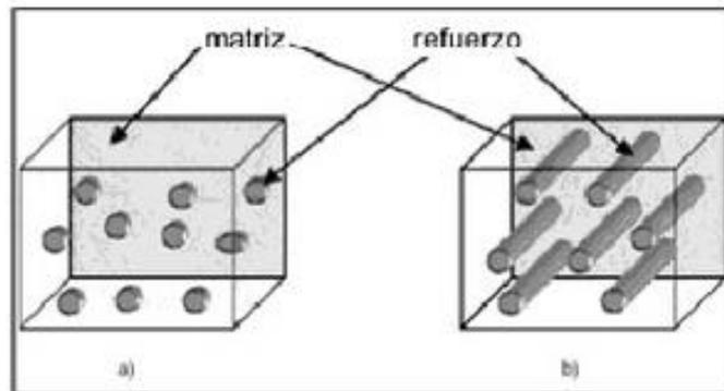
Figura 2.1. Material compuesto. a) Con partículas, b) con fibras. [7]
