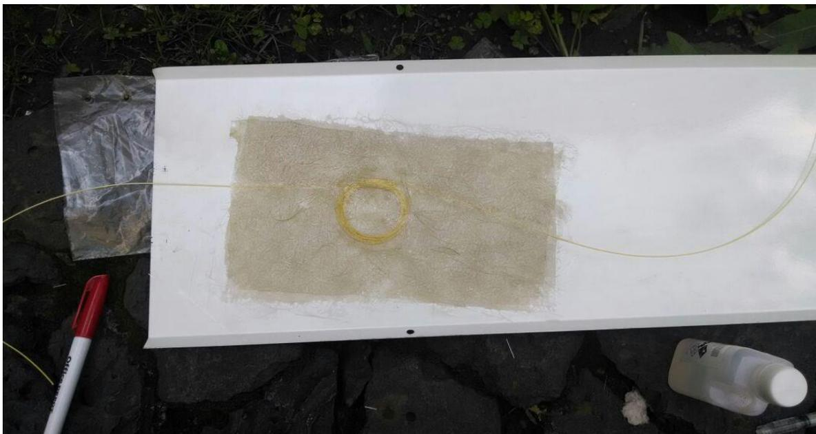
Figura 3.5. Fibra óptica SMF-28 embobinada y embebida en fibra de vidrio, dejándola secar.
