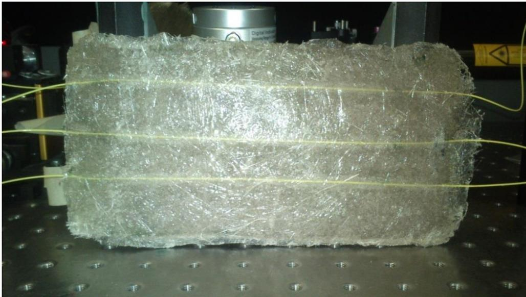
Figura 3.18. Arreglo 2. Fibra óptica estirada embebida en fibra de vidrio.
