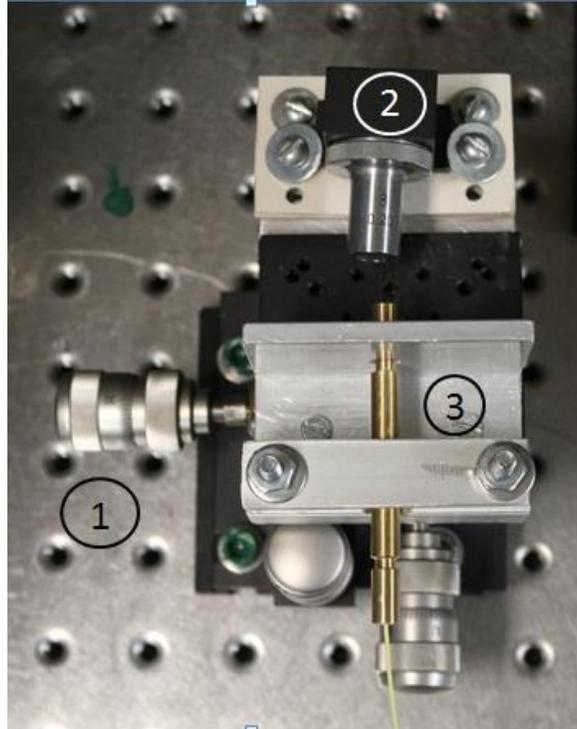
Figura 3.17. Segundo acoplamiento. 1) Unidad de desplazamiento en tres ejes, 2) Lente, 3) Conector.
