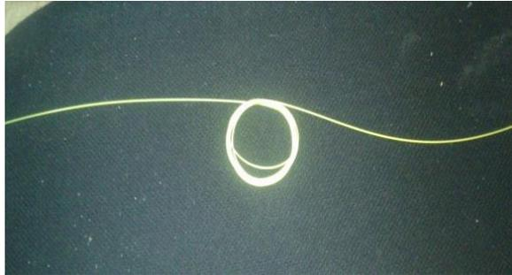
Figura 3.1. Arreglo 1, Fibra óptica SMF-28 ya embobinada.
