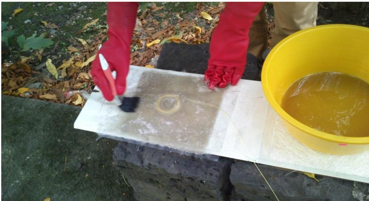
Figura 3.3. Colocando la fibra óptica SMF-28 en la fibra de vidrio.
