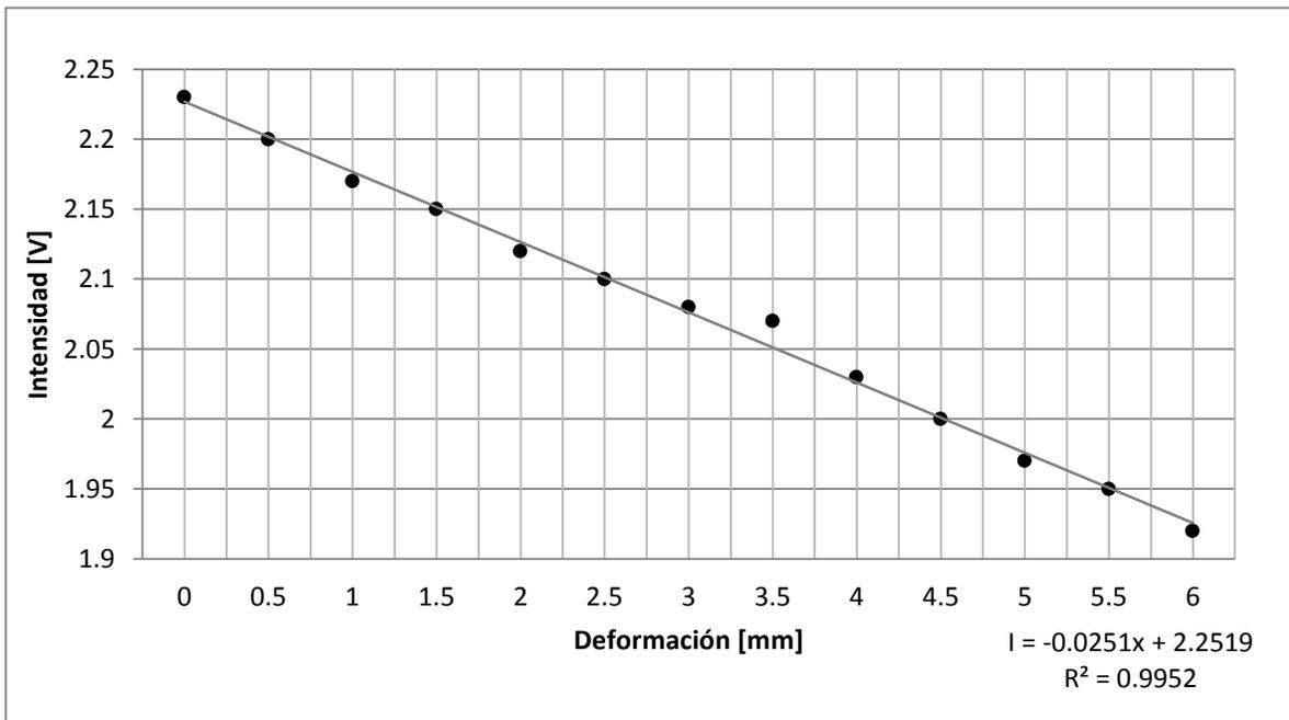
Figura 3.22. Gráfica y línea de tendencia colocando una placa polarizadora a 45°.
