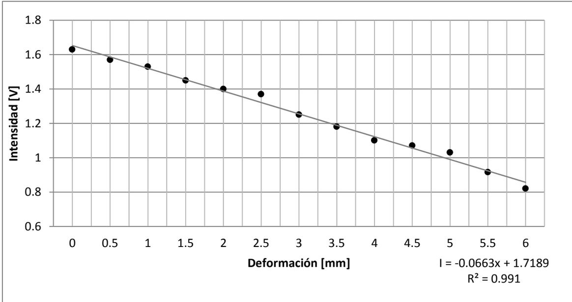
Figura 3.26. Gráfica y línea de tendencia colocando una placa polarizadora a 90°.
