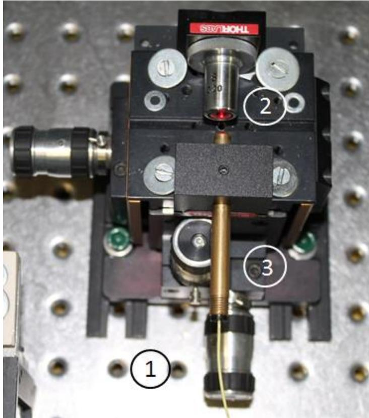
Figura 3.14. 1) Unidad de desplazamiento en tres ejes, 2) Lente, 3) Conector óptico.
