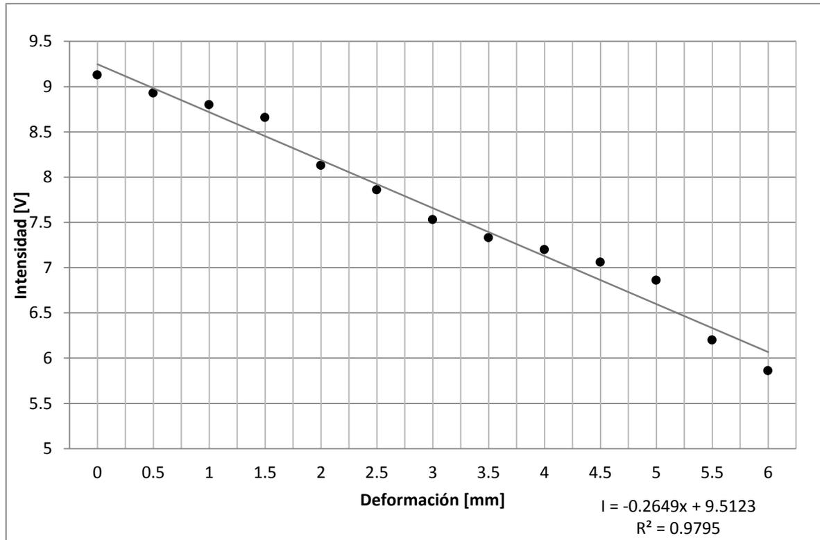
Figura 3.19. Gráfica y línea de tendencia cuando la fibra óptica es conectada directamente al fotoreceptor.
