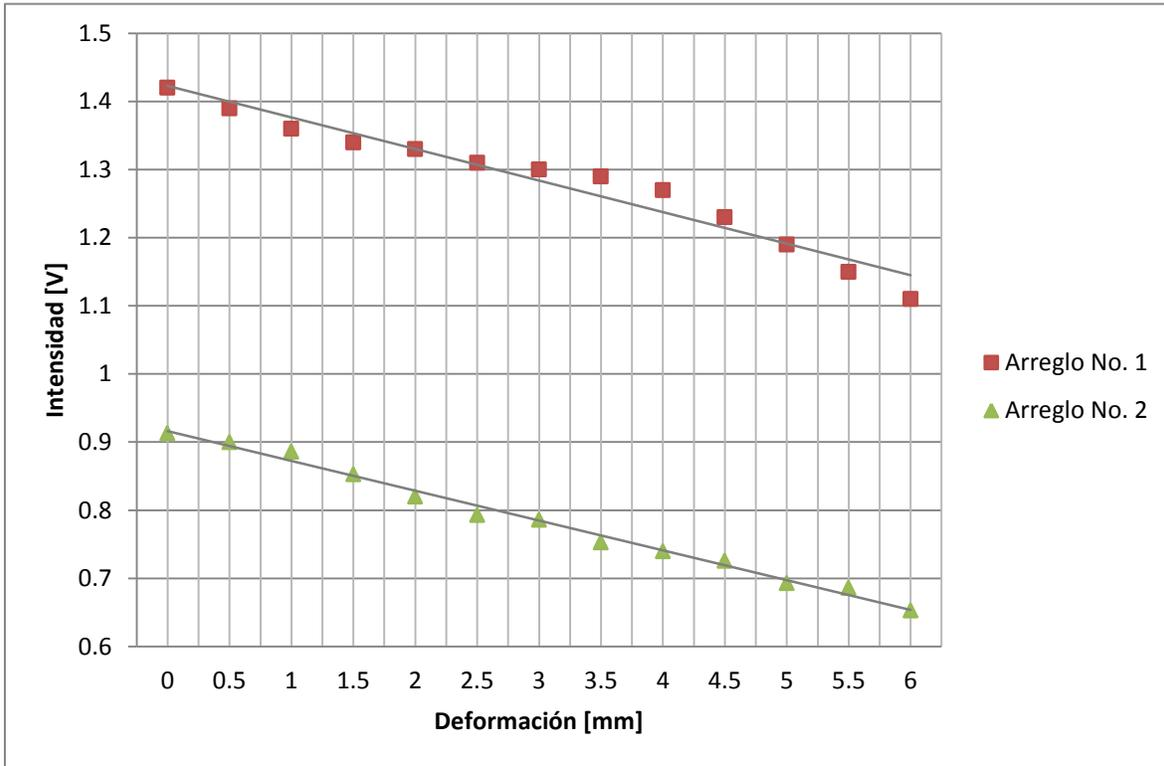
Figura 4.5 Gráficas y líneas de tendencia colocando la placa polarizadora a 0°.
