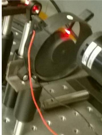
Figura 3.9. Obturador colocado en la instrumentación experimental.
