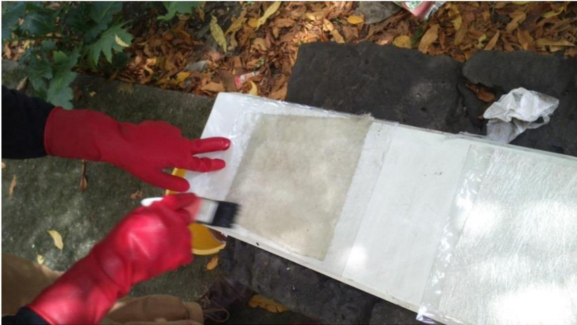
Figura 3.2. Cubriendo un fragmento de fibra de vidrio con la mezcla entre la resina y el catalizador, utilizando como base un acetato.
