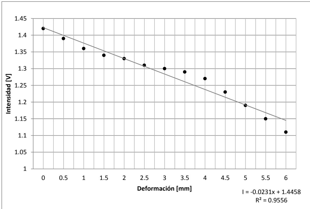
Figura 3.20. Gráfica y línea de tendencia colocando una placa polarizadora a 0°.
