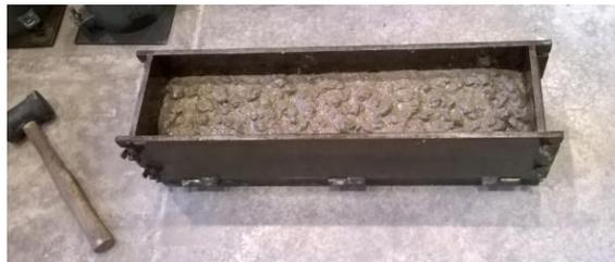
Fig. 3.8 – Elaboración de viga.
