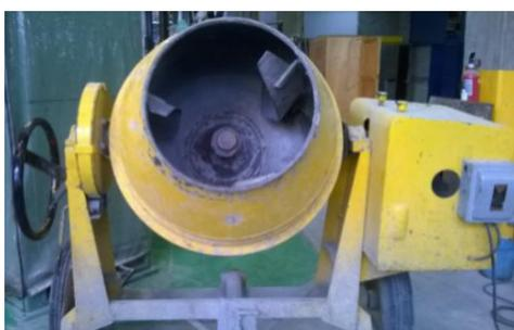
Fig. 3.2 – Revolvedora mecánica.
