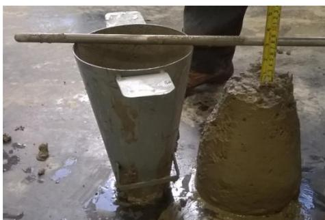
Fig. 3.6 – Prueba de revenimiento.
