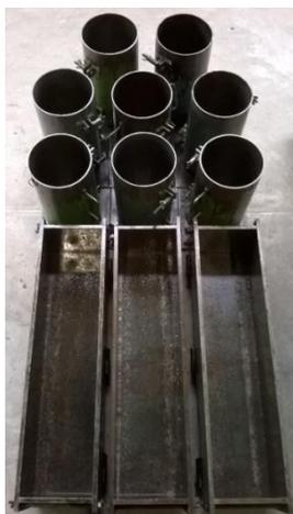
Fig. 3.1 – Moldes utilizados.
