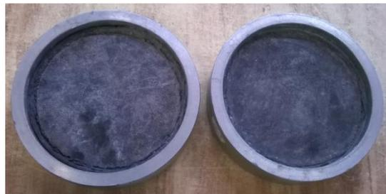
Fig. 3.12 – Cabezales de neopreno
