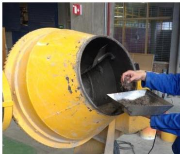
Fig. 3.5 – Adición de fibras
