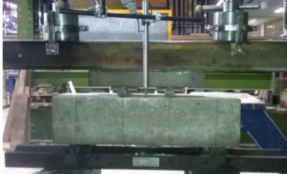
Fig. 3.15 – Ensayo de viga a flexión.
