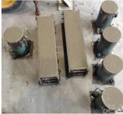
Fig. 3.9 – Especímenes recién fabricados
