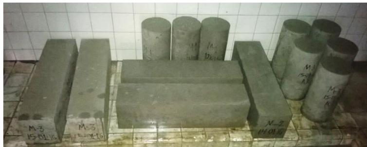
Fig. 3.11 - Especímenes en la cámara de curado.
