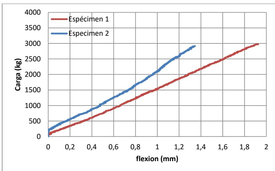
Figura 4.6 – Ensayo de flexión en la mezcla M-2 (5 kg/m<sup>3</sup>)
