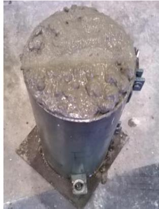
Fig. 3.7 – Elaboración de cilindro
