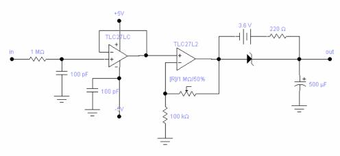
Figura 3.5 Amplificador de señal de pH
