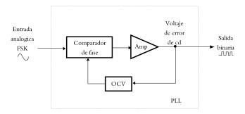
Figura 6.6 Demodulador FSK
