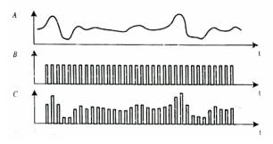
Figura 4.5 Señal muestreada
