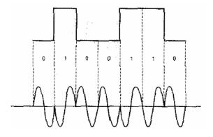
Figura 6.7 Modulación BPSK
