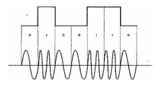
Figura 6.4 Modulación FSK
