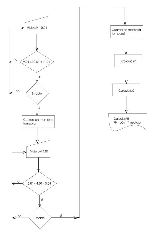
Figura 9.1 Diagrama de flujo para la calibración
