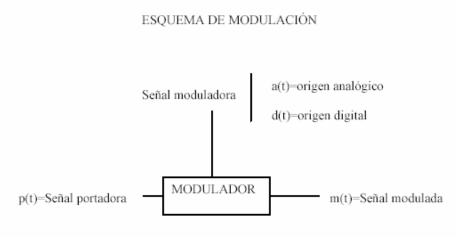
Figura 6.2 Esquema de modulación
