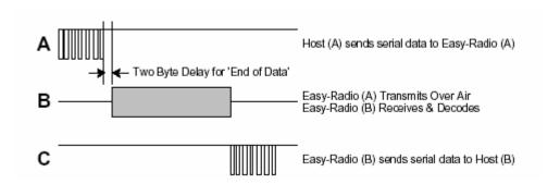
Figura 6.10 Transmisión de datos Easy-Radio
