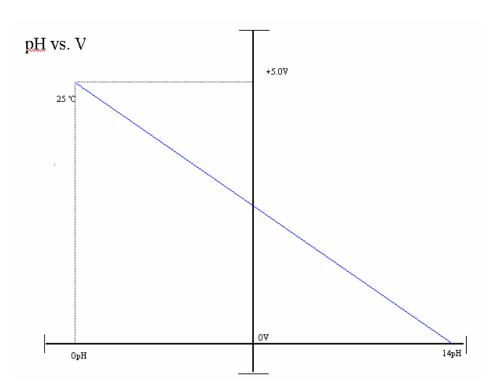
Figura 3.3 Señal de pH amplificada
