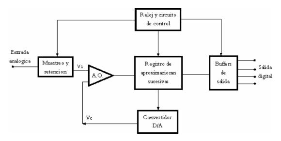
Figura 4.8 Convertidor A/D de aproximaciones sucesivas
