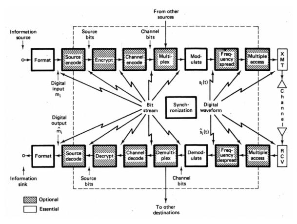
Figura 6.1 Sistema de comunicación digital
