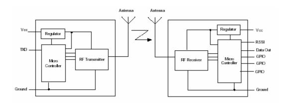
Figura 6.8 Módulo RF Easy-Radio
