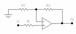
Figura 3.2 Amplificador no inversor
