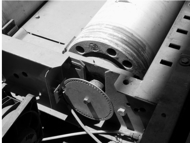
Figura 3.3. Arreglo para la medición de la velocidad.
