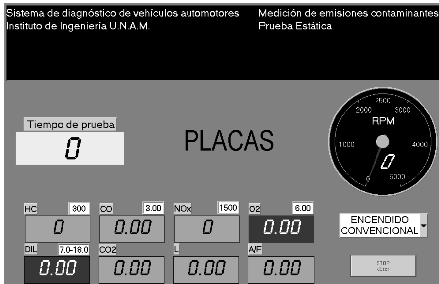
Figura 2.24. Prueba estática de medición de gases.
