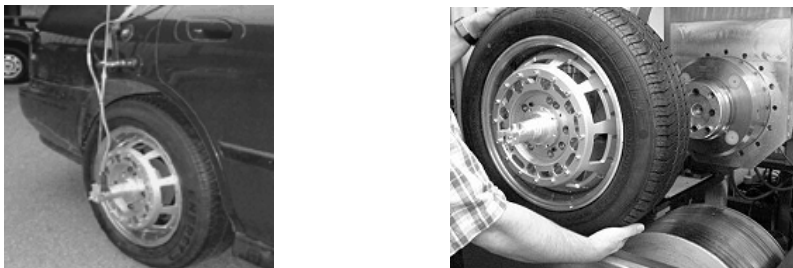
Figura 1.23. Instalación de torsiómetros en las ruedas motrices de automóviles
