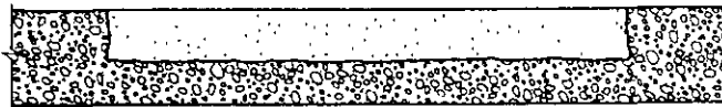
(b) Parche colocado adecuadamente. La zona labrada deberá tener una profundidad mínima de 2 cm y sus bordes deben tener ángulos rectos o estar socavados hasta la superficie.
