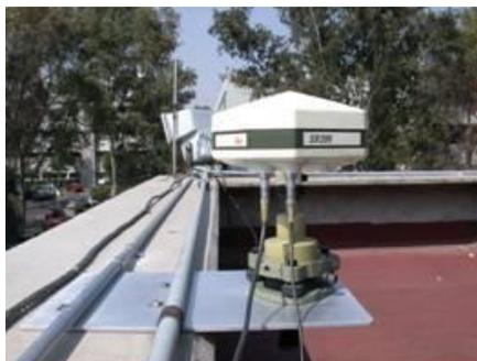
*Figura 10.- La instalación más sencilla y económica, está anclado a una base existente de concreto en la azotea de la DICyG, sostenido mediante una placa de aluminio especialmente torneada para ajustarse a la base nivelante y la brida que sujeta a la antena.*
