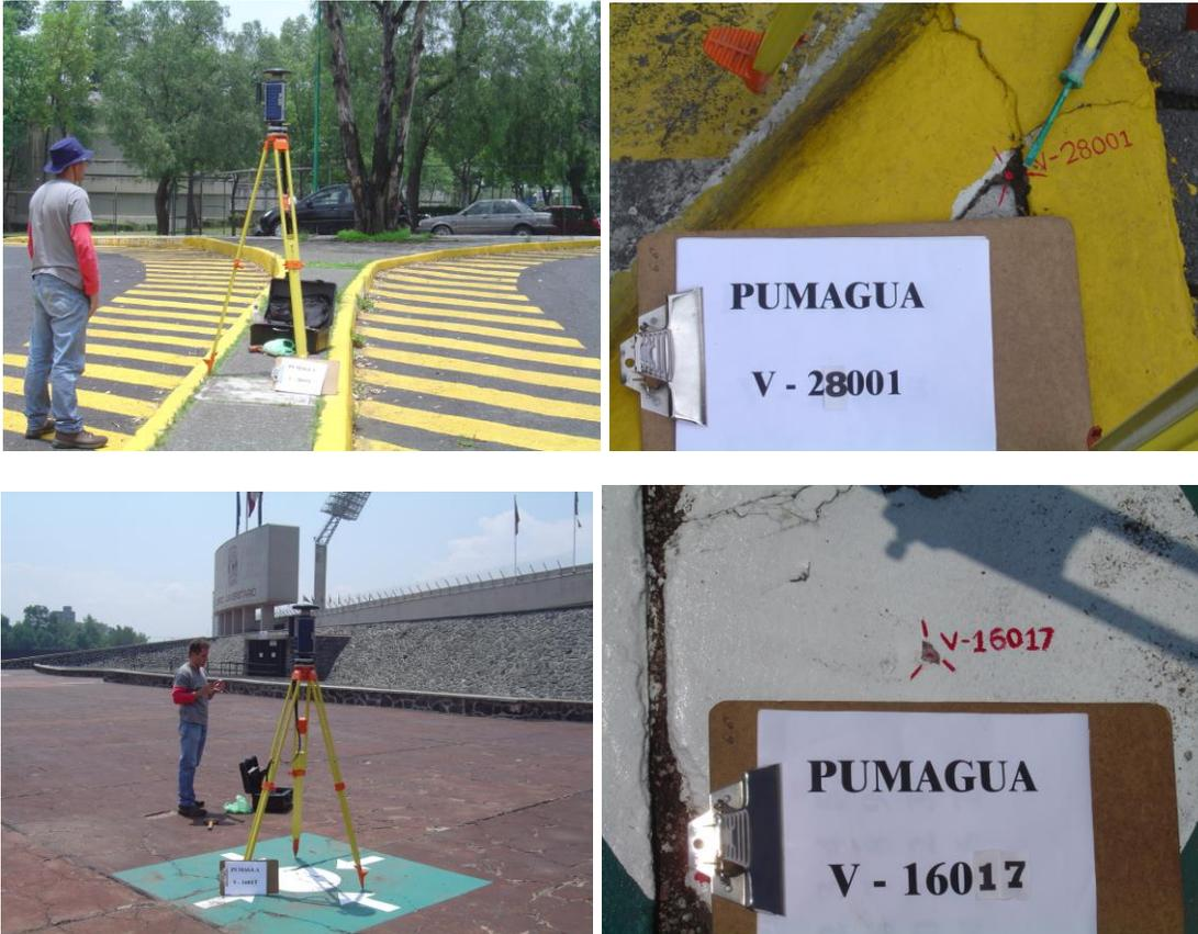
*Figura 19.- Se observa a la izquierda el modo de preparación de la medición móvil con el sistema Z-Max de Thales. A la derecha se observa la forma en la que se ubican los puntos de control y de encuentro en donde el detalle se observa muy tanto en campo como en la fotografía para su ubicación en la restitución.*
