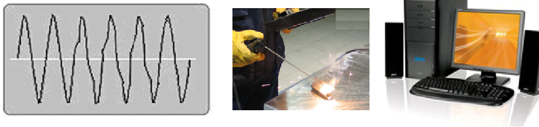
Fig.3.10 Dispositivos que generan armónicos y su forma de onda
