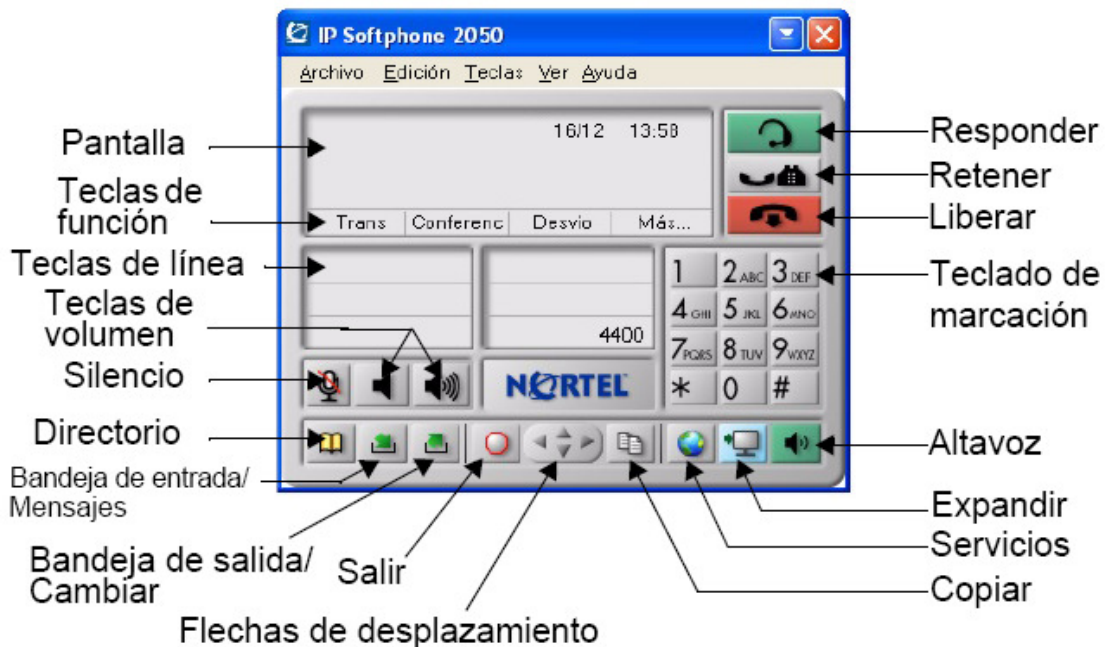
Figura 4.2 Ventana compacta del control de llamada
