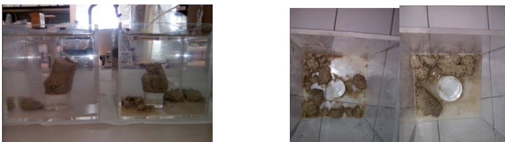
Figura 6.12 Monolitos de CAC blanco colapsados al pasar 2.25 días.
