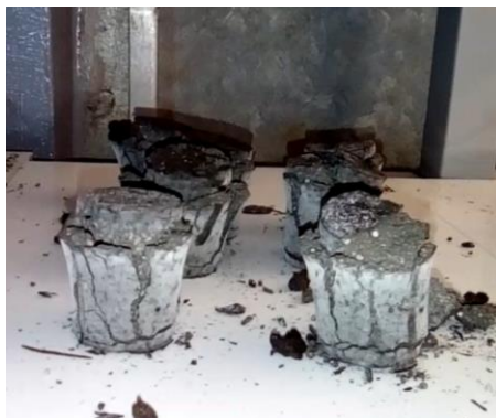
Figura 5.9 Probetas que no fraguaron elaboradas con CAC.
