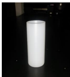
Figura 5.7 Molde para monolitos cilíndricos.
