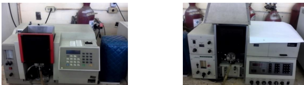
Figura 5.4 a) Espectrofotómetro de absorción atómica Perkin Elmer 3110, b) Espectrofotómetro de absorción atómica Perkin Elmer Analyst 100.
