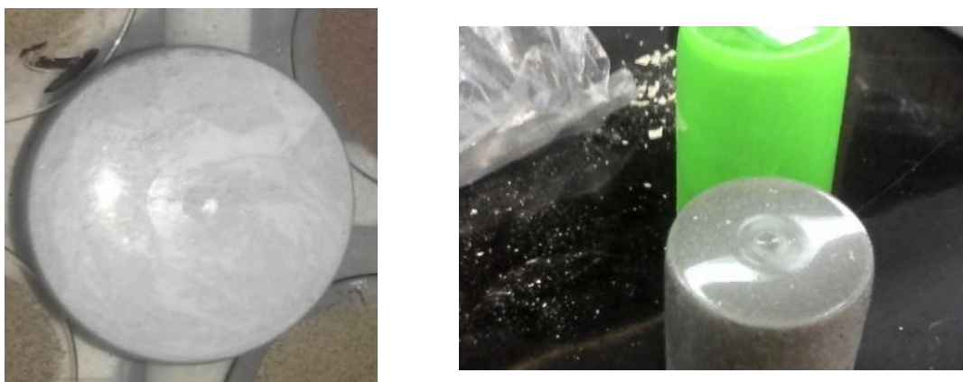
Figura 6.3 Brillo del monolito debido al acabado espejo.
