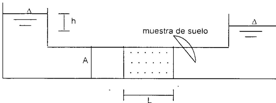
Fig. 5.1 Permeámetro de carga constante.
