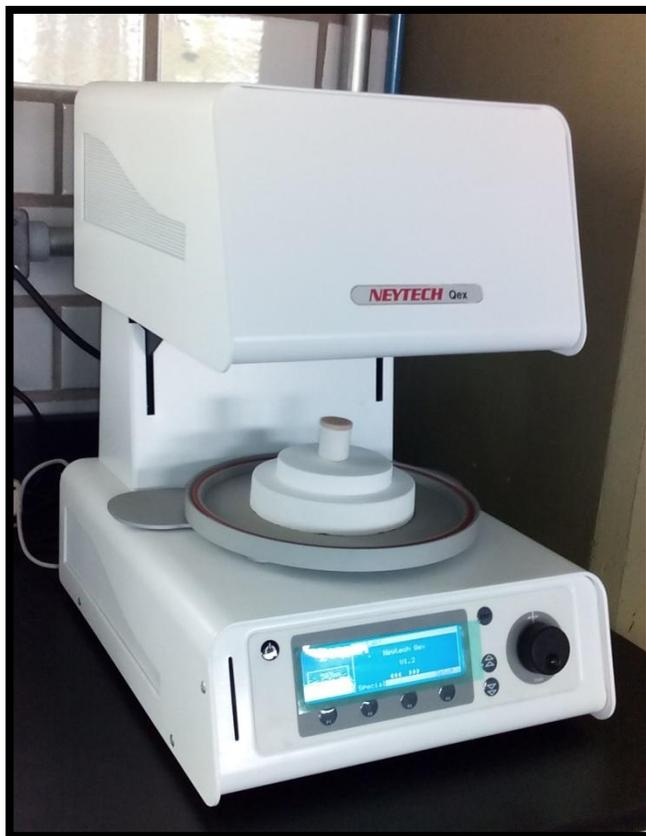
Fig. 6.2 Horno con muestra en su interior.
