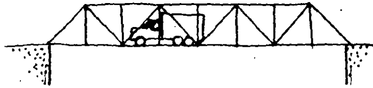
Armadura de paso a través
