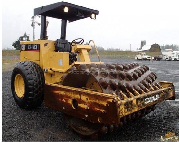
Fig. 2.2 Compactador pata de cabra.
