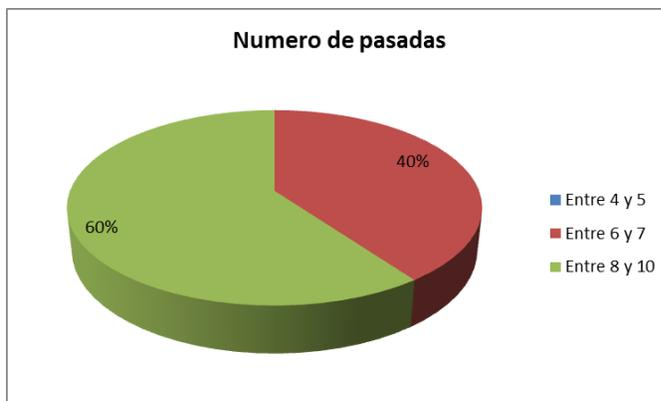
El número de pasadas depende del espesor, el peso del equipo y las recomendaciones del laboratorio de control de calidad, por lo general se dan de 8 a 10 pasadas con equipo de compactación liso vibratorio.
