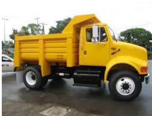
Fig. 2.7 Camión rabón de 7m<sup>3</sup> de capacidad.
