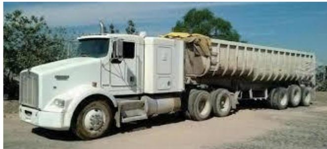
Fig. 2.9 Góndola de 30m<sup>3</sup> de capacidad.
