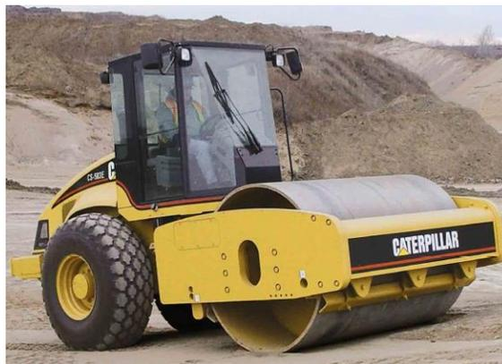
Fig. 2.3 Compactador por presión.
