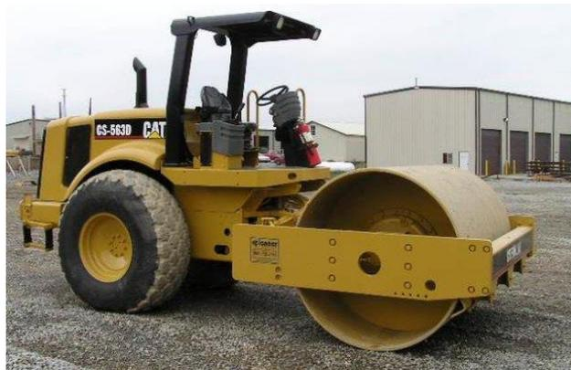
Fig. 2.5 Compactador liso vibratorio.
