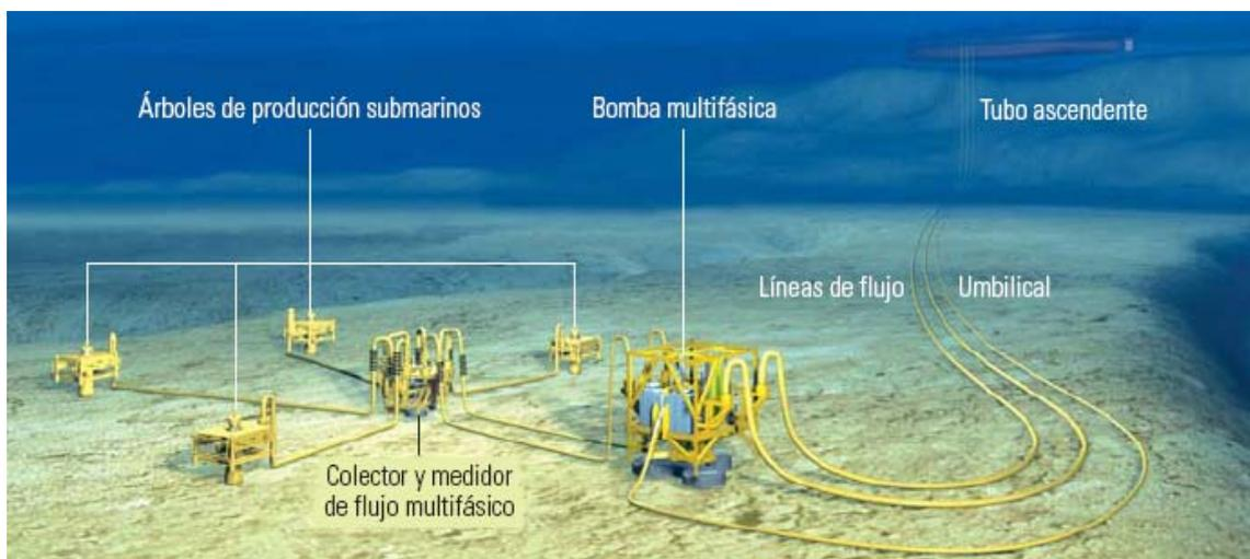
**Figura 3.1.** Sistema submarino a tierra (subsea-to-shore) que incluye bomba multifásica, colector, árboles de producción submarinos y líneas de flujo<sup>2</sup>
