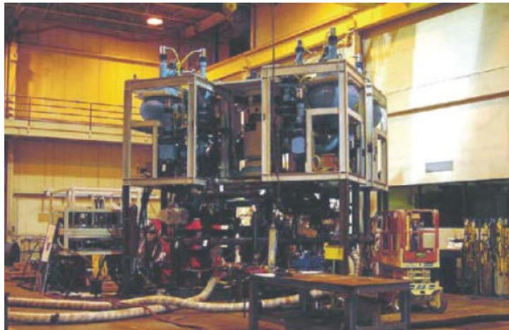
Figura 4.6. Bomba de levantamiento submarino de lodo MLP<sup>7</sup>
