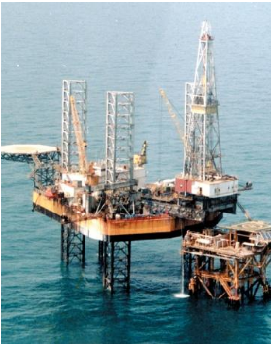
Figura 1.11 Plataforma auto elevable tipo Jack up
