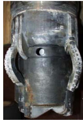
Figura 2.7 Zapata después del desplazamiento, lista para la cementación.
