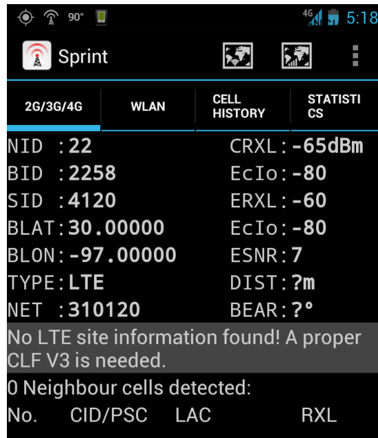
Figura 6.20 Prueba de Handover usando la terminal en modo de ingeniería
