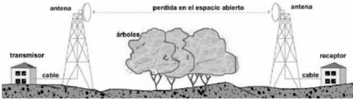
Figura 4.14 Enlace de radiobases mediante microondas.
