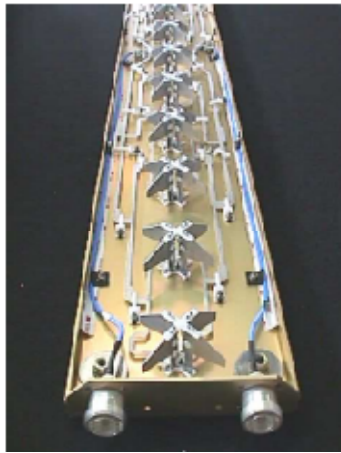
Figura 4.17 Composición interna de una antena sectorial.
