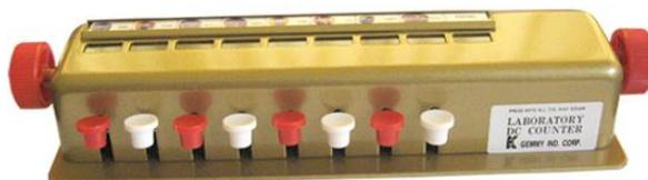
Ilustración 2.9. Contador Mecánico de Células CC8A (Ref. 6)
