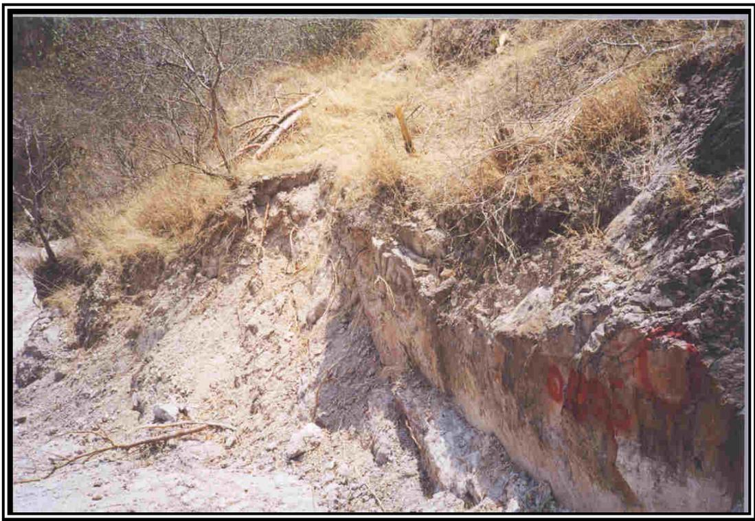
**Fotografía 4.-** En esta imagen se aprecia el plano de la falla Arroyo 2 y también el espesor de material cataclástico que la rellena.
