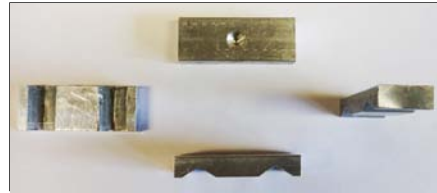
Figura 3.30 Distribuidores de fuerza.
