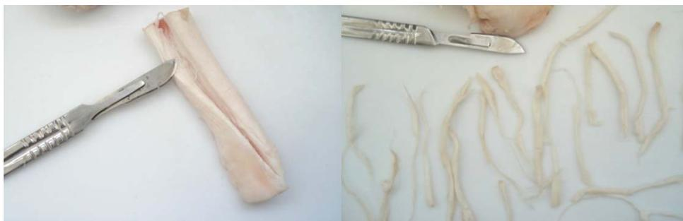
Figura 23. Cortes de Tendón para la separación de fibras
