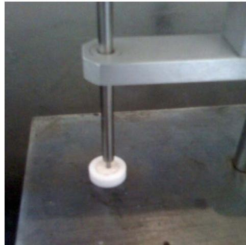
Figura 25. Determinación de los tiempos de fraguado indentación.
