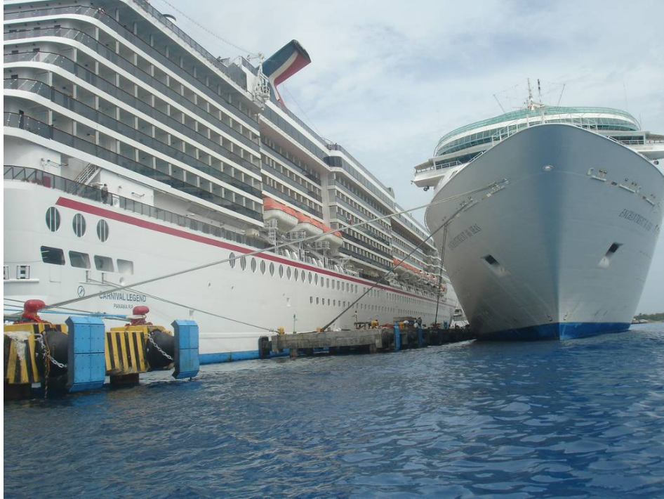
Figura 3.8 Atraque simultaneo de dos embarcaciones con ayuda del duque de Alba
