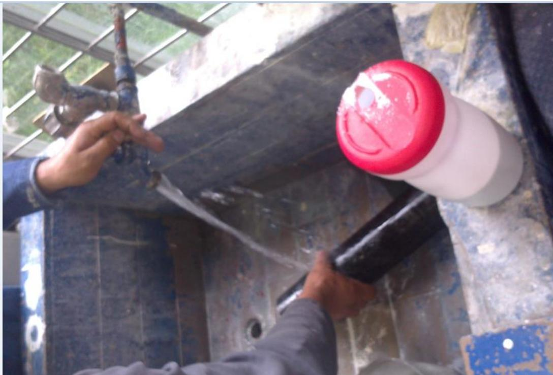
*Figura 5.9 Enfriamiento de la pieza. Una vez que se soldaron todos los elementos del mezclador, se procedió a enfriarlo.*
