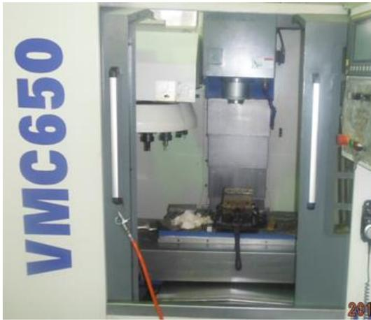
*Figura 5.4. En esta máquina se cortaron los elementos que serían insertados en la sección de tubería.
