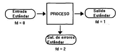
Figura 3. Canales de E/S asociados a un proceso en UNIX.
