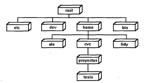
Figura 2. La estructura jerárquica del sistema de archivos de UNIX.
