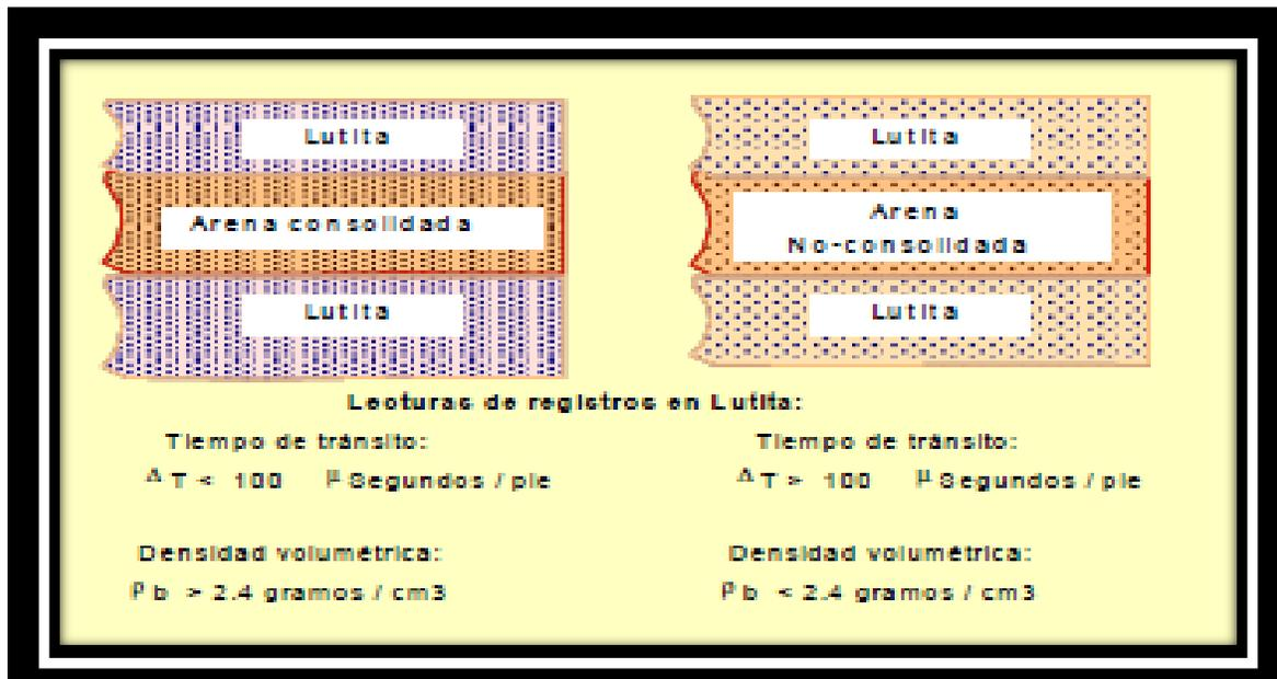
**Fig. 5.3.- Respuesta de los registros sónico y densidad en arenas. (10)**
