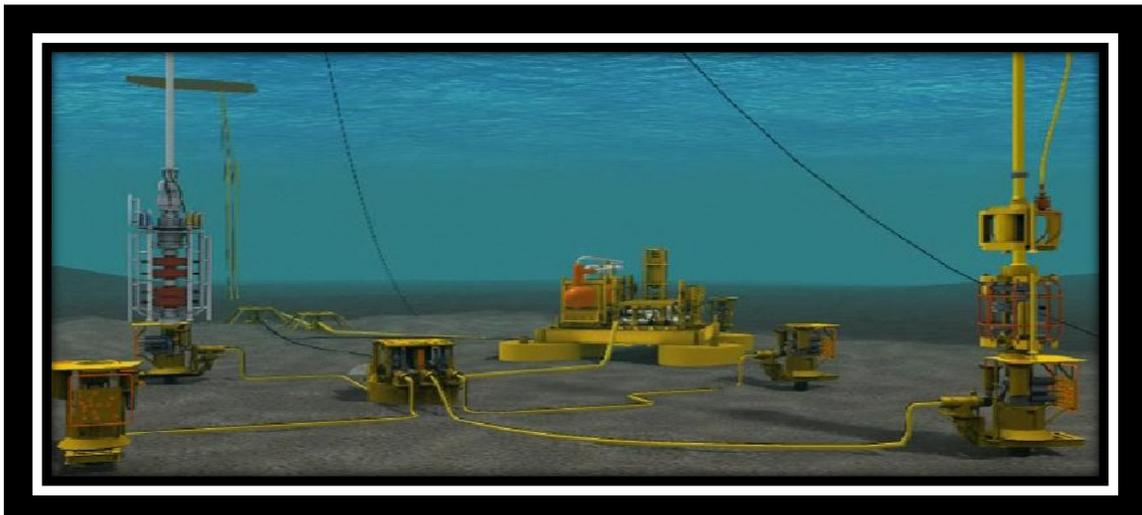
**Fig. 2.2.- Equipo de producción submarino.**
